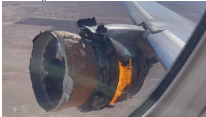
Figura 2 - Motor PW4000 com danos severos
